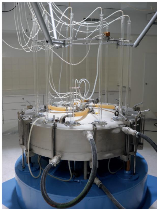
ISCADOR-Mischmaschine zur Wirkstoffherstellung
